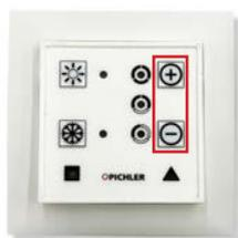
Die zwei Tasten auf der rechten Seite verändern die Lüftungsstufe des Gerätes. Mit der [+] Taste wird die Lüftungsstufe so lange erhöht, bis Stufe III erreicht wird, was einem Stoßlüftungsvorgang entspricht. Nach 1 Stunde Betriebsdauer in der höchsten Lüftungsstufe stellt sich automatisch wieder der Normallüftungsbetrieb auf Stufe 2 ein. Alternativ können Sie den Stoßlüftungsbetrieb auch vor Ablauf der einen Stunde manuell beenden. Hierzu drücken Sie einfach die [-] Taste Ihrer Bedieneinheit.
