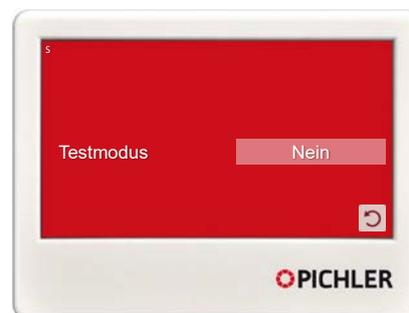
Hier kann der Testmodus mit [Ja] aktiviert und mit [Nein] deaktiviert werden. Mit den Relais H2, H3, H5, H67, H9, H10, H11, H12A und H12B können die einzelnen Ausgänge angesteuert werden
