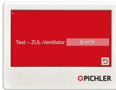
Um den Zuluftventilator manuell zu testen, muss zuerst der Testmodus auf [Ja] aktiviert werden. Danach kann unter Test – ZUL-Ventilator der Volumenstrom manuell vorgegeben werden. Um den Testmodus zu beenden, muss der Testmodus mit [Nein] deaktiviert werden.
