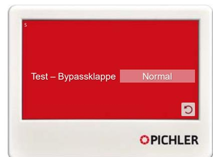
Mit der Funktion Test – Bypassklappe kann die Bypassklappe manuell in die Wärmerückgewinnung (WRG) oder Bypassposition gefahren werden. Mit [Normal] wird die Klappenposition wieder automatisch gesteuert.
