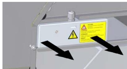
Für Reinigungszwecke ist die Voreinheit sorgsam aus dem Lüftungsgerät herauszuziehen. Dabei ist auf den elektrischen Anschluss zu achten. Dieser darf nicht beschädigt werden.
