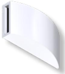
Zuluftventil für Wandmontage mit optimierten akustischen Eigenschaften. Kulissen mit Oberfläche aus Glasseide. Abmessungen: BxHxT = 337x175x90 mm
