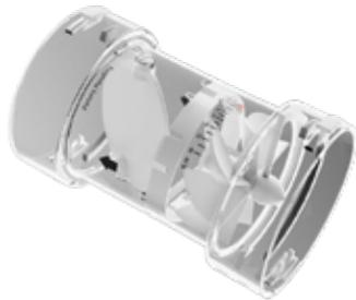
Ein "All-in-One" Gerät zum Messen und Einstellen des Luftvolumenstromes. Bestehend aus einer Messturbine, einer farbigen Nadel und einer Skala, die auf dem transparenten Körper aufgedruckt ist. Dies ermöglicht ein sofortiges Ablesen des Luftvolumenstromes (m³/h). Die Verstellung der Regelklappe erfolgt
