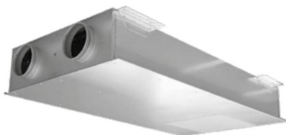
**Kombinierte Zu- und Abluftbox mit zwei integrierten VAV / CAV-Kompaktreglern und integrierten Umlenkschalldämpfern, sowie integrierten Rohrschalldämpfern zur Dämpfung des Telefoneschalls. Mit oder ohne MP-Bus-Schnittstelle in linker oder rechter Ausführung.**
