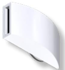
Zuluftventil für Wandmontage mit optimierten akustischen Eigenschaften. Kulissen mit Oberfläche aus Glasseide. Abmessungen: BxHxT = 337x175x90 mm
