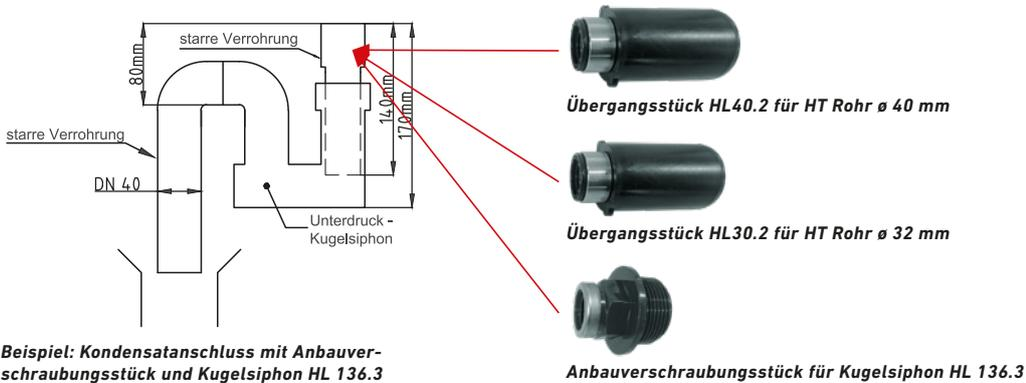
Beispiel: Kondensatanschluss mit Anbauverschraubungsstück und Kugelsiphon HL 136.3
