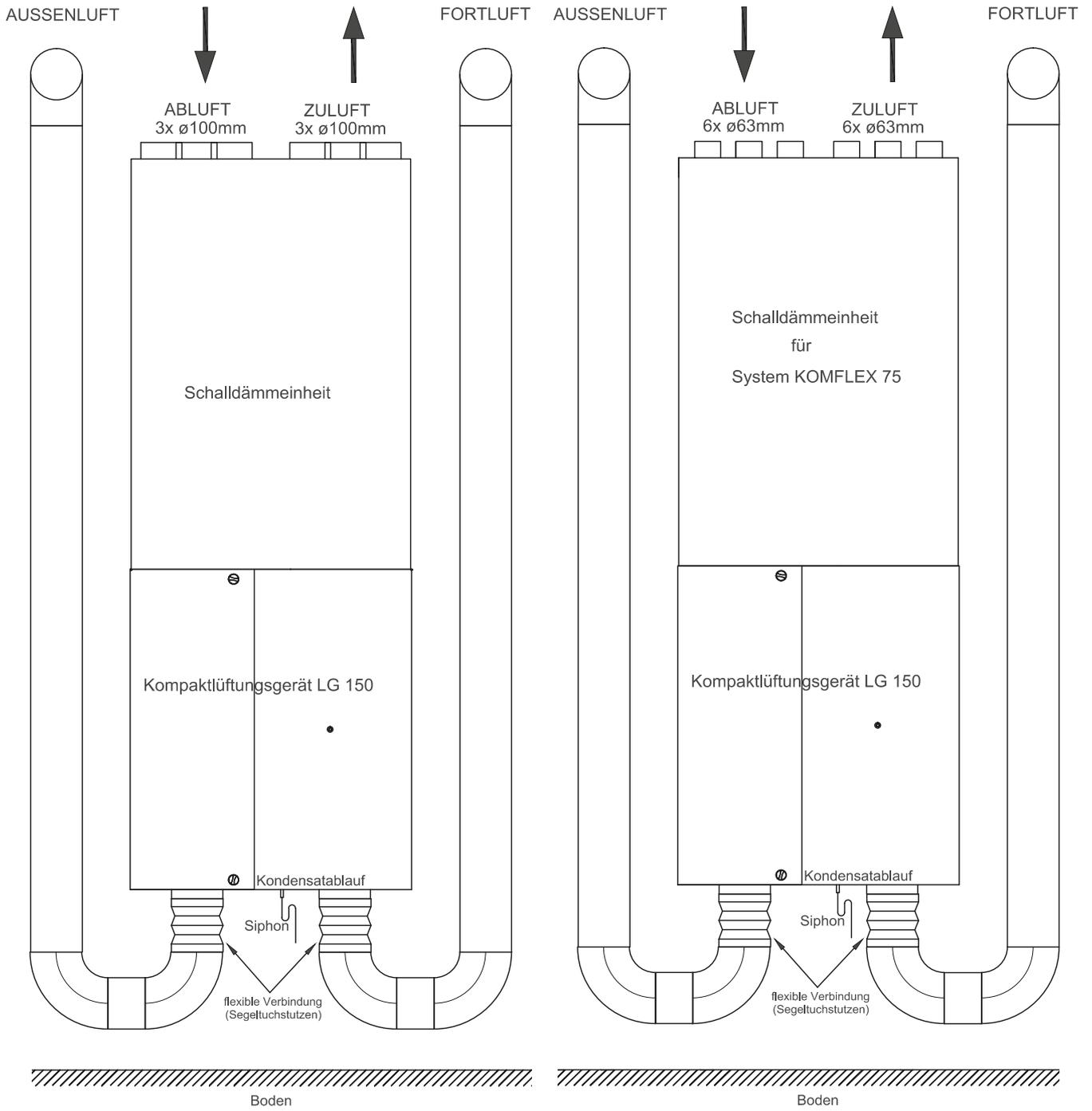
DETAIL KONDENSATANSCHLUSS WAND, BEI VERSION MIT STANDARDTAUSCHER SIEHE SEITE 19
