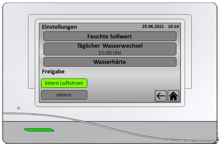
Alternativ kann das Gerät noch über einen zusätzlichen externen Befehl freigegeben werden. Dabei kann zwischen einem digitalen Eingangssignal oder externer Modbusanbindung gewählt werden (siehe *elektrischer Anschluss Kapitel 13*).
