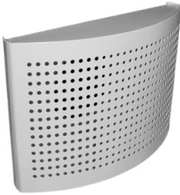
Aus verzinktem Stahlblech, für Wandmontage vorgesehen. Ein niedriger Geräuschpegel, große Wurfweite mit hoher Induktion und somit eine zugfreie Luftverteilung kennzeichnen das STQA. Die abnehmbare Frontplatte erleichtert das Reinigen, Messen und Einstellen
