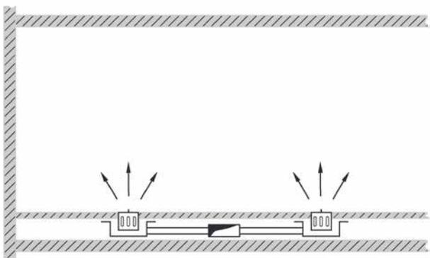
Die Fußbodenauslässe sind über Anschlusskästen mit dem Zuluftkanal verbunden.
