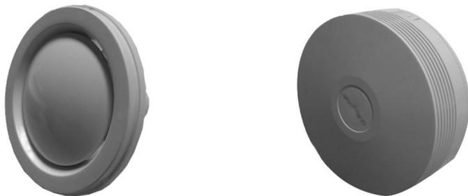
Das Abluftventil ist in Vollkunststoffbauweise gefertigt. Seine äußere Form ist an die herkömmliche Form der fest einstellbaren Abluftventile angelehnt, um einen problemlosen Austausch zu ermöglichen. Der Antrieb des Ventils erfolgt über eine geräuschlose thermoelektrische Vorschubeinheit. Grund- und Hauptlüftung sind in weiten Bereichen unabhängig voneinander einstellbar. Der elektrische Anschluss erfolgt über eine Steckverbindung. Für Kanäle NW 100.
