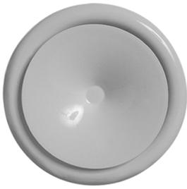
Das Ventil besteht aus verzinktem Stahlblech. Einfache Montage durch Verdrehen am Einbaurahmen. Die Luftmengenregulierung erfolgt durch Verdrehen des Ventiltellers.
