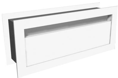
Wegen des Differenzdruckes strömt mit Hilfe des Durchlasses, Luft von einem Raum in einen anderen über und zwar durch den rechteckigen Schlitz in der Frontscheibe. Der SK hat eine schalldämmende Funktion. Als Dämpfungsmaterial wird Mineralwolle verwendet.
