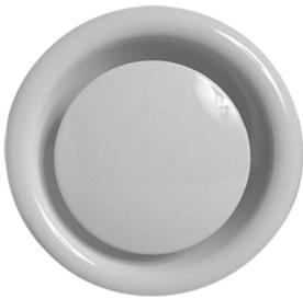
Das Ventil besteht aus verzinktem Stahlblech. Geeignet für Deckenmontage. Schnelle und einfache Montage durch Verdrehen am Einbaurahmen. Die Luftmengenregulierung erfolgt durch Verdrehen des Ventiltellers.
