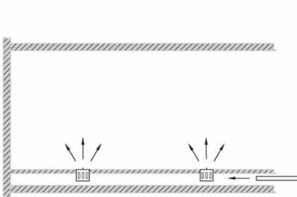
Luft wird in den Raum unter dem Doppelboden befördert. Die Luftzufuhr in den Raum wird durch statischen Druck erzwungen.
