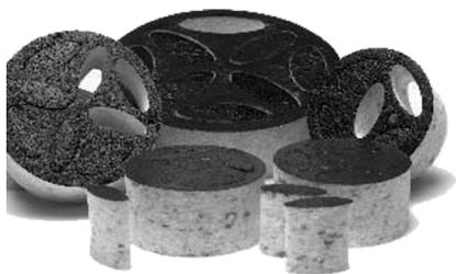
Inno ist ein Schalldämmkern für runde Luftkanäle. INNO besteht vollständig aus weichem elastischem Kunststoffschäum mit guten Dämpfungseigenschaften. Der Schalldämmkern hat eine Reihe von ovalen Öffnungen, die mit herausnehmbaren Stopfen ausgestattet sind. Der Druckabfall am Schalldämmkern wird durch Variieren der Anzahl der offenen Löcher angepasst. Inno kann sowohl in Zuluft- als auch in Abluftanlagen verwendet werden.
