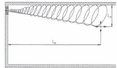
Abb. 4 Darstellung horizontale und vertikale Eindringtiefe
