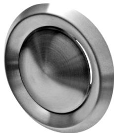
Zu- bzw. Abluftventil aus Edelstahl (18/10 304), wird inkl. Einbaurahmen, Federn und Schrauben geliefert. Es ist temperaturbeständig bis +100 °C. Einfache Montage durch Verdrehen am Einbaurahmen (KKL). Die Einstellung und Luftmengenregulierung erfolgt durch
