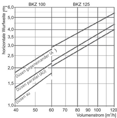
Abb. 2 Horizontale Wurfweite [m] in Abhängigkeit vom Volumenstrom
