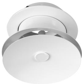
Aus verzinktem Stahlblech, für Deckenmontage vorgesehen. Der Ventilkörper ist mit einer Gummidichtung ausgestattet. Die Einstellung der gewünschten Position erfolgt durch Verdrehen des Ventiltellers und wird durch einen Verriegelungsstift gesichert. Der Luftstrom kann durch die mitgelieferte Sektor-
