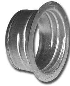
Der Einbaurahmen KKL wird mit Schrauben oder Nieten am Rohr befestigt. Das Abluftventil wird im Einbaurahmen durch Verdrehen befestigt. Bei Verwendung des Schalldämpfers DBL wird dieser am Ventil montiert.
