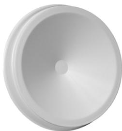
Aus verzinktem Stahlblech, eignet sich für Deckenmontage in Büro- und Wohnräumen etc.. Der Ventilkörper ist mit einer Schaumstoffdichtung ausgestattet. Eine Sektorplatte ermöglicht einen kontrollierten Luftaustritt. Einfache Montage durch Verdrehen am Einbaurahmen (KKL). Die Luftmengenregulierung erfolgt durch Verdrehen des Ventil-tellers.
