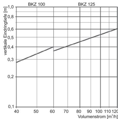
Abb. 3 Vertikale Eindringtiefe [m] in Abhängigkeit vom Volumenstrom
