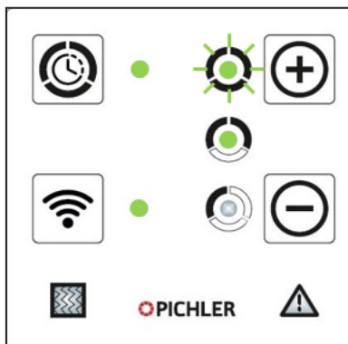
Livello di ventilazione 2
