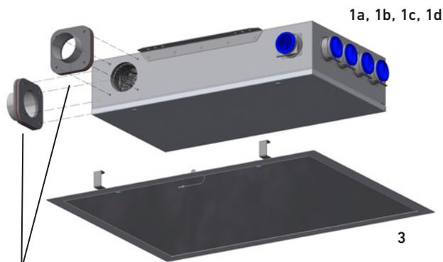
Il montaggio dei collegamenti è variabile di lato o sul lato posteriore. I bocchettoni di raccordo ODA / EHA DN 100 sono dotati o privi della guarnizione a labbro.
