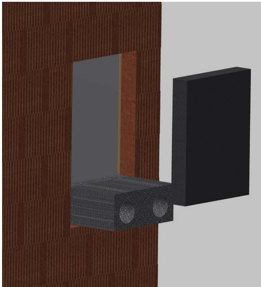
*Pegar el aislamiento de compensación mediante espuma adhesiva WDVS*
